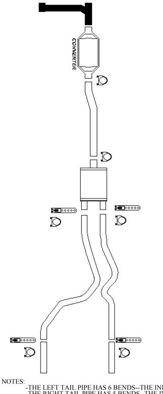
NOTES: -THE LEFT TAIL PIPE HAS 6 BENDS--THE INLET IS THE LONG END -THE RIGHT TAIL PIPE HAS 5 BENDS--THE INLET IS THE SHORT END -THE MUFFLER OUTLETS SHOULD BOTH BE PARALLEL TO THE GROUND AND RUN SIDE BY SIDE
